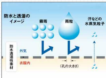
雨をシャットアウトし、蒸れを放出する防水透湿性素材を採用。雨粒や濃霧よりも小さく、汗などの水蒸気粒子よりも大きいサイズの無数の孔で快適性を保つ。
