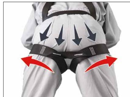
墜落制止時にヒップサポーターが張ることで腿ベルトが上へずれにくく、内腿への圧迫を軽減。
