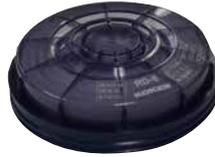
フィルタの繊維密度を上げることで捕集効率を高めることができる紙フィルタは、吸気抵抗の規格をクリアするためにろ過面積を広げる必要があります。極細径の繊維をラウンドブリーツ状に一体抄紙成型したのがアルファリングフィルタRD-6型です。コンパクトな形状で、低い吸気抵抗を実現しています。
