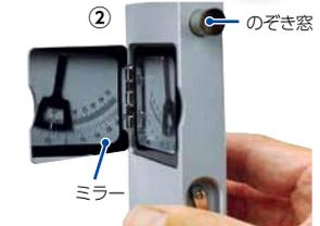
改良型の裏面には傾斜(角度)とtan目盛があるので、対象物までの距離が分かれば、対象物の高さに分かる
