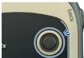
本体右側にあるクリックスティックは、上下左右に動かせるのに加えて、押すことでクリック。本体側面にあるボタンと組み合わせることで、手袋をしたままでも操作が可能
