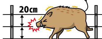
電気さくは、四方を確実に囲い、できるだけ24時間運転にしましょう。必要なさく線の長さは、設置距離×段数(動物による)。必要な支柱の本数は、設置距離÷3m間隔(平坦な場所)になります。
