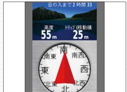
安定したGPS受信に貢献するマルチGNSS(GPS/GLONASS/Galileo/みちびき(補完信号))、3軸電子コンパスや気圧高度計を内蔵。
